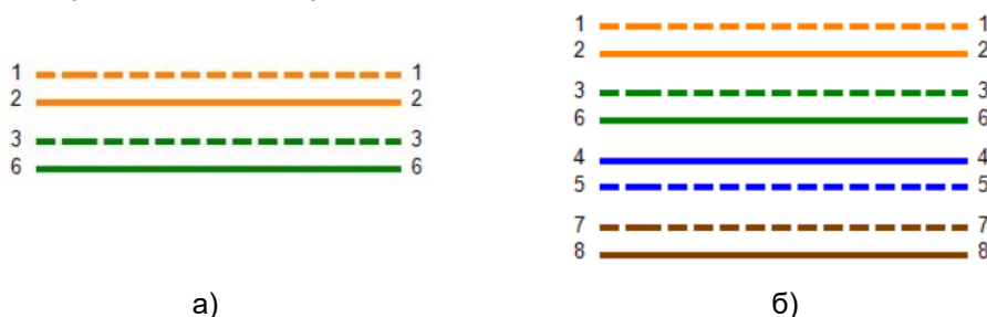
Рис. 2. Схема разводки кабеля: а) - для Fast Ethernet; б) - для Gigabit Ethernet
